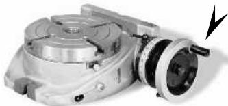
Povolte páčky (viz obr.) otočením proti směru hodinových ručiček a pootočte nonius-objímkou ve směru hodinových ruček, dokud není uvolněná. Šneková hřídel je nyní rozpojena z ovládání stolu, aby umožnila jeho manuální otáčení. Pro zapojení šnekové hřídele vraťte objímku zpět a utáhněte páčku.
