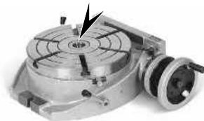
Nonius je vyznačen na objímce. Minimální odečet je 10'', což znamená, že stupně a minuty odečítáte na mikro-objímce a sekundy na noniusu. Stůl lze použít i ve vertikální poloze ve spojení s koníkem.
