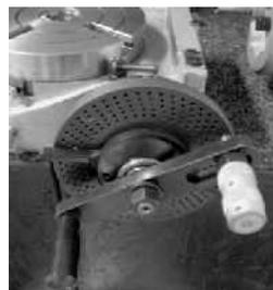
Přípevnění dělicí desky ke stolu se provede po vyjmutí kola (viz. obr.). Upevněte dělicí desku na objímku pomocí 4 šroubů, nasuňte vymežovací přípravek na šnekovou hřídel a výstřednou hřídel a zajistěte jej plošnou pružinou v zářezu hřídele. Nasuňte klíčku na konec šnekové hřídele a zajistěte jej podložkou a maticí. Rozevřete vymežovací přípravek tak, aby mezi jeho rameny byl požadovaný počet otvorů na zvolené kružnici. Utáhněte šroub na přípravku.
