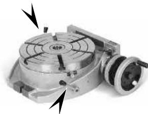
Stůl je vybaven stupnicí indikující úhel pootočení. Indikátor slouží k označení úhlu pootočení na stupnici. Můžete jej seřídít a nastavit po povolení šroubu (viz obr.) pohybem v drážce. Po nastavení opět šroub utáhněte.
