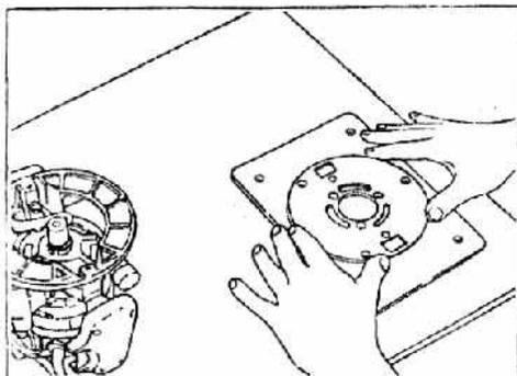
2/ označte si na desce stolu montážní otvory pro připevnění základny frézky
